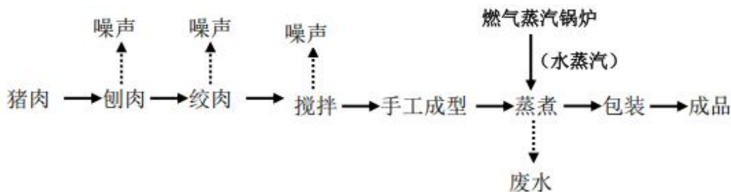
图 2-3 项目肉糜制品生产工艺流程图
