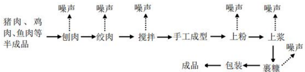
图 2-3 项目裹粉类鱼、肉制品生产工艺流程图
