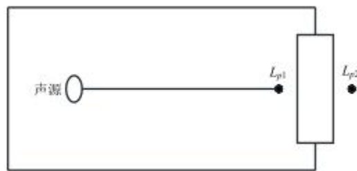
图 4-3 室内声源等效为室外声源图例
